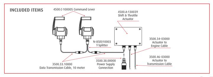
4500 SERIES SYSTEM FOR USE WITH SINGLE STATION CONTROL, TWIN ELECTRONIC ENGINE (0-5 VDC) AND ELECTRIC SHIFT GEARBOX
